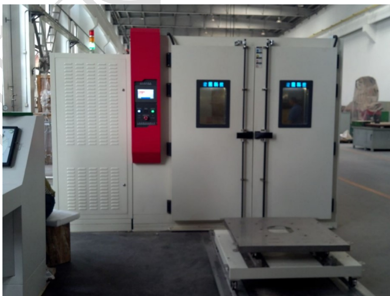
图 2 步入式高低温交变湿热试验箱布置图
