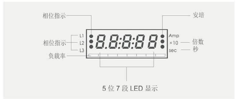
3相电流值2秒间隔循环显示
